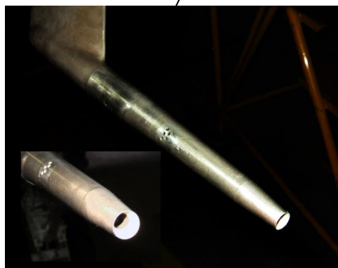
Pitotova trubice z letounu F/A-18 Hornet
